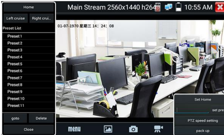
Рис. 49 Пресеты для управления PTZ IP видеокамерой
