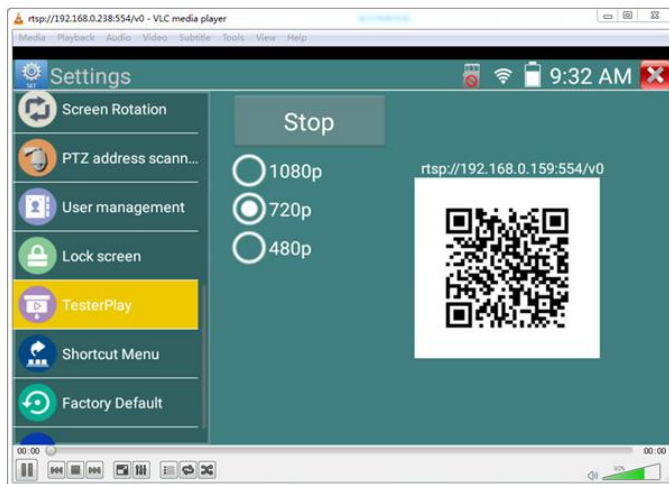
Рис. 22 Пример трансляции изображения на ПК с тестера с помощью VLC плеера
