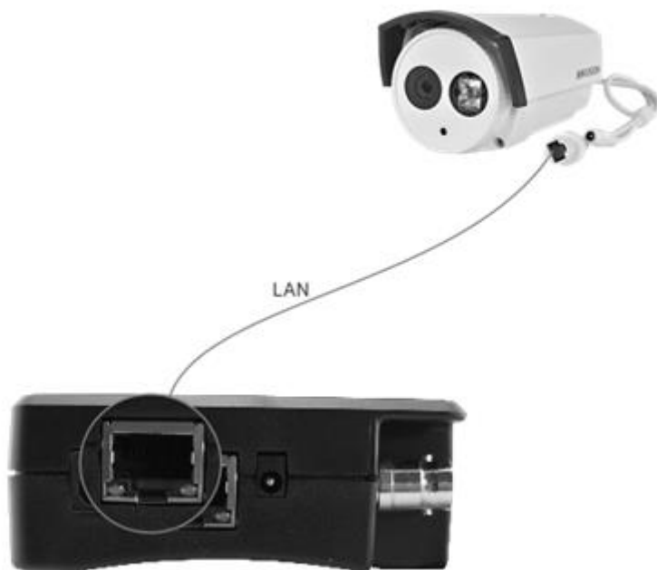
Рис. 8 Подключение IP-видеокамеры к тестеру
