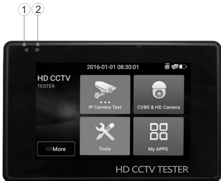
Рис. 3 TIP-H-4(Hand), индикаторы на передней панели
