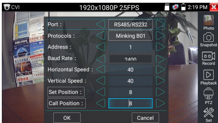
Рис.77 Управление PTZ CVI видеокamerой по интерфейсу RS232/485
