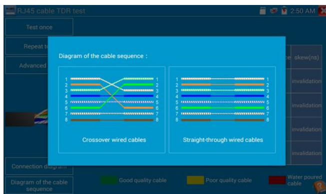
Рис. 104б Типы обжимки кабеля «витой пары»
