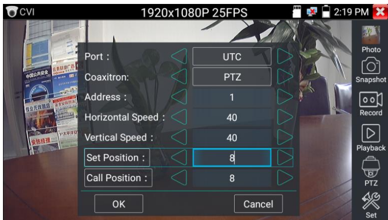
Рис. 76 Настройка заданной позиции и вызов пресета
