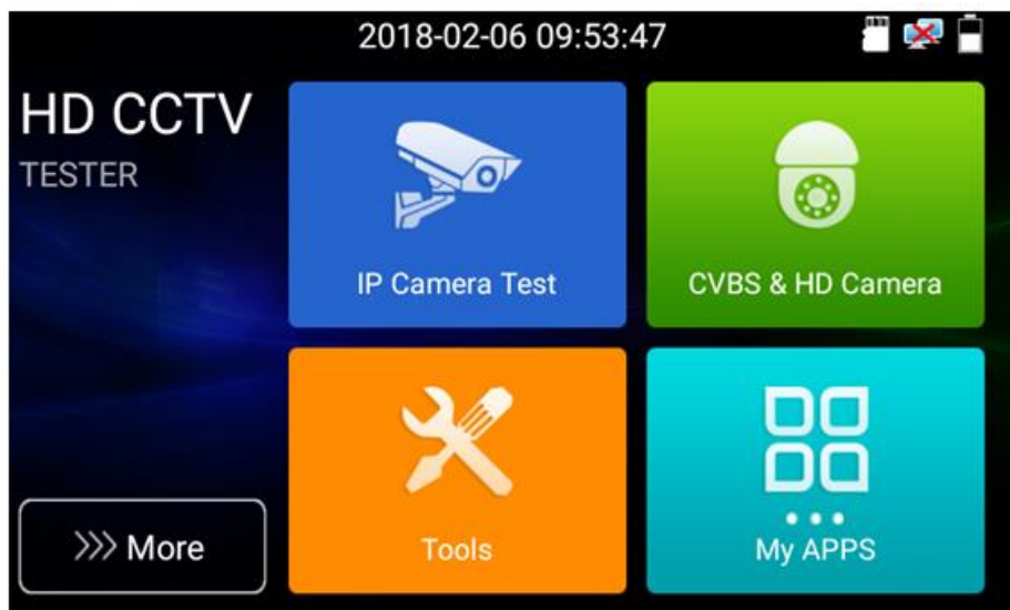
Рис. 13 «Lite» режим экранного меню тестера
